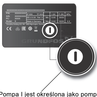
Rys. 65 Identyfikacja pompy nadrzędnej na pompie podwójnej
